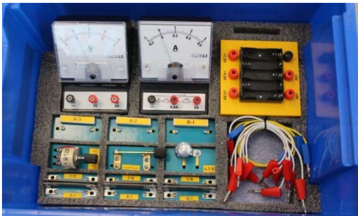
Рис. 2. Оборудование комплекта для проведения экспериментов по электродинамике
