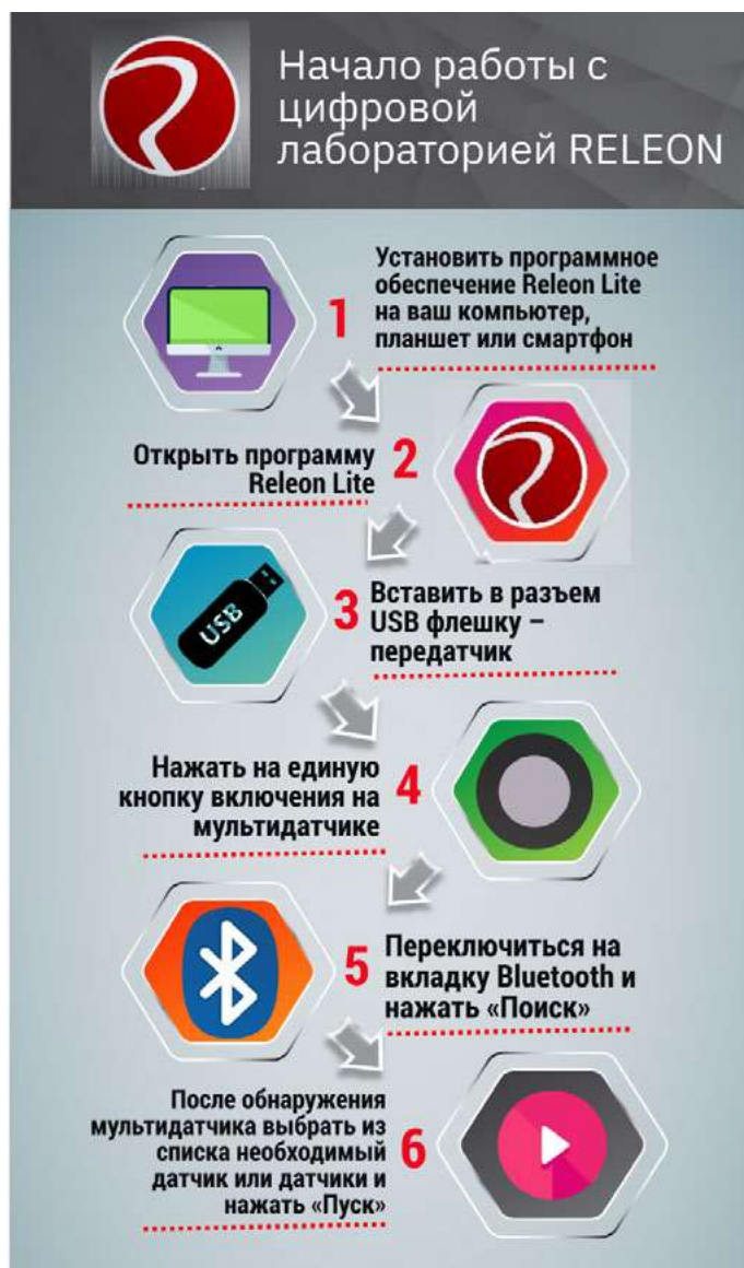
Рис. 21. Инфографика «Начало работы с цифровой лабораторией Releon»
