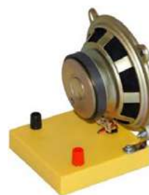
Рис. 2. Динамик низкочастотный на подставке
